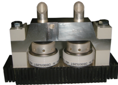
1000MW 汽轮发电机旋转励磁机整流组件 (2支整流管, 并联)
